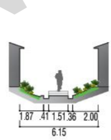
CORTE 4-4 PASAJE VIRGEN DEL CARMEN VIA PAVIMENTADA 6.15 ml
